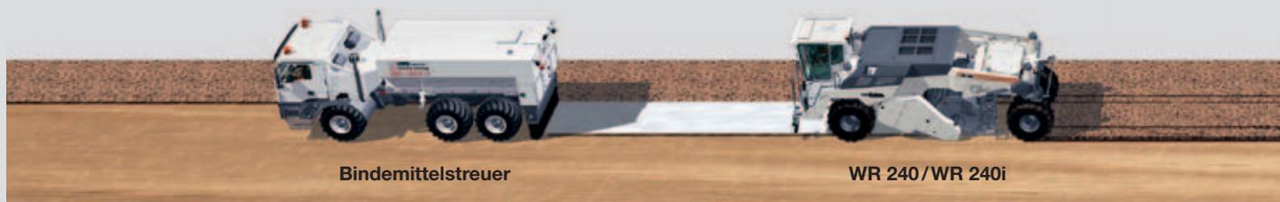
Bodenstabilisierung mit Zement
