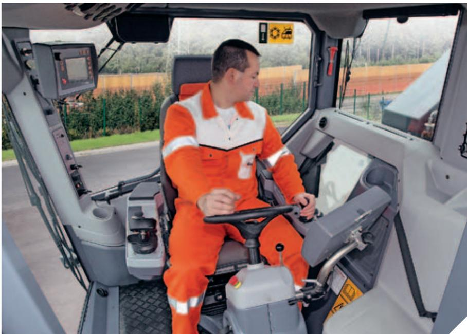
Das Farbdisplay an der Lenksäule ist im direkten Blickfeld des Bedieners positioniert ▼
