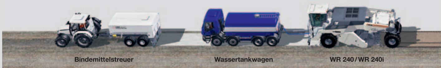
Zur Homogenisierung granuliert der leistungsstarke Fräs- und Mischrotor des WR 240/WR 240i den anstehenden Boden ohne Bindemittelzusätze und lockert ihn auf. Während ein Grader die Profilierung des so aufbereiteten, homogenen Bodengemischs ausführt, nehmen verschiedene Hamm Walzen dessen Verdichtung vor.
