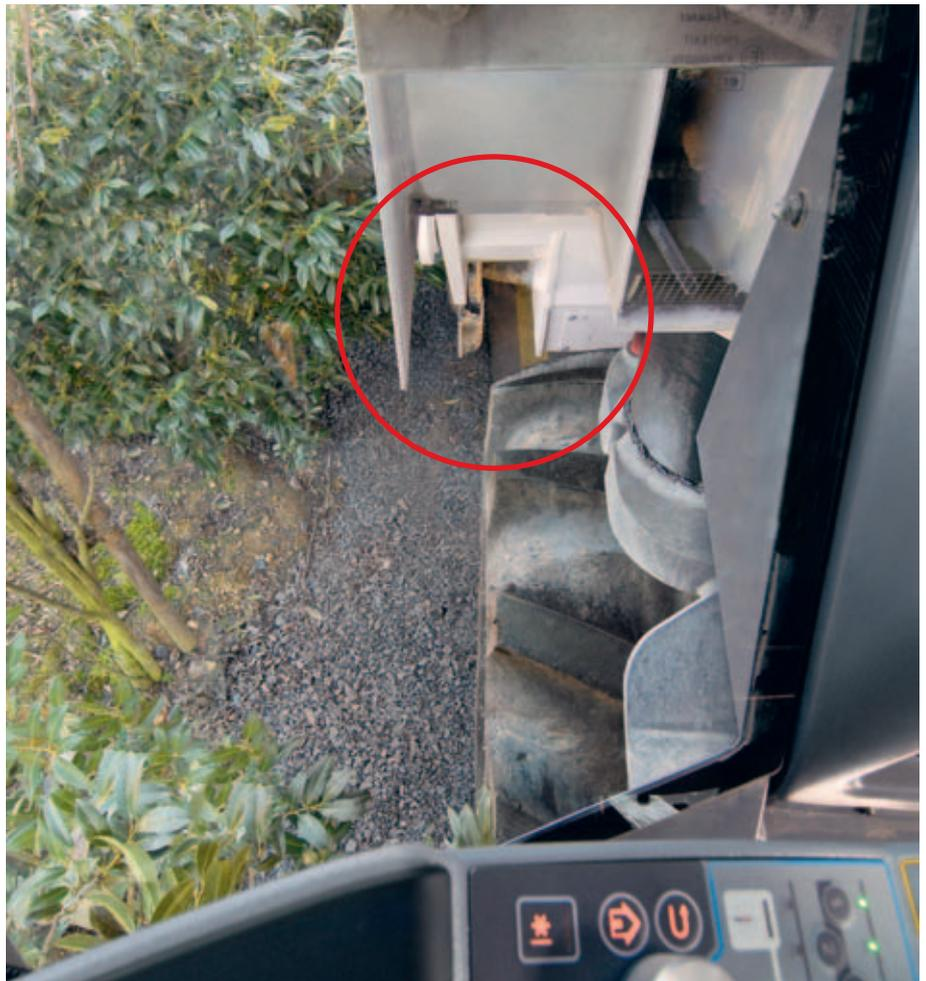
➤ Dank der guten Sicht auf die rechte Maschinenarbeitskante kann an Randeinfassungen von Fahrbahnen optimal präzise recycelt werden.
