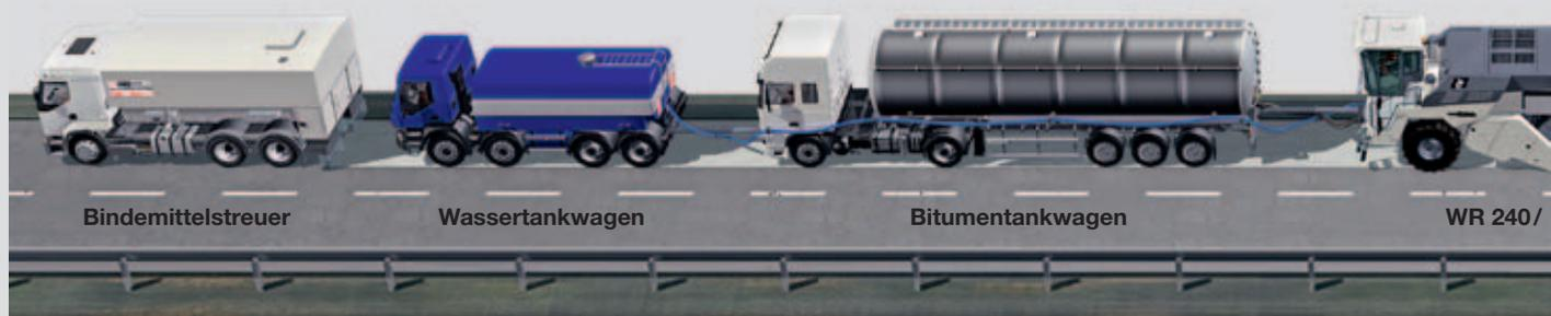
Recycling mit Zementsuspension und Schaumbitumen
