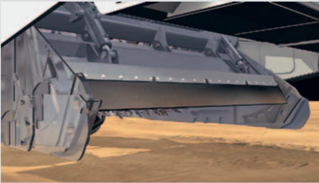
Die vordere, weit öffnende Walzenklappe ist mit einer Brecherleiste ausgestattet, ...
