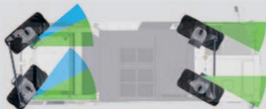
**Modus Kurvenfahrt – mit Überlenken:** Bei Erreichen eines bestimmten Lenkwinkels können zusätzlich die Hinterräder per Lenkrad eingeschlagen werden. Das Überlenken ermöglicht noch kleinere Wendekreise.
