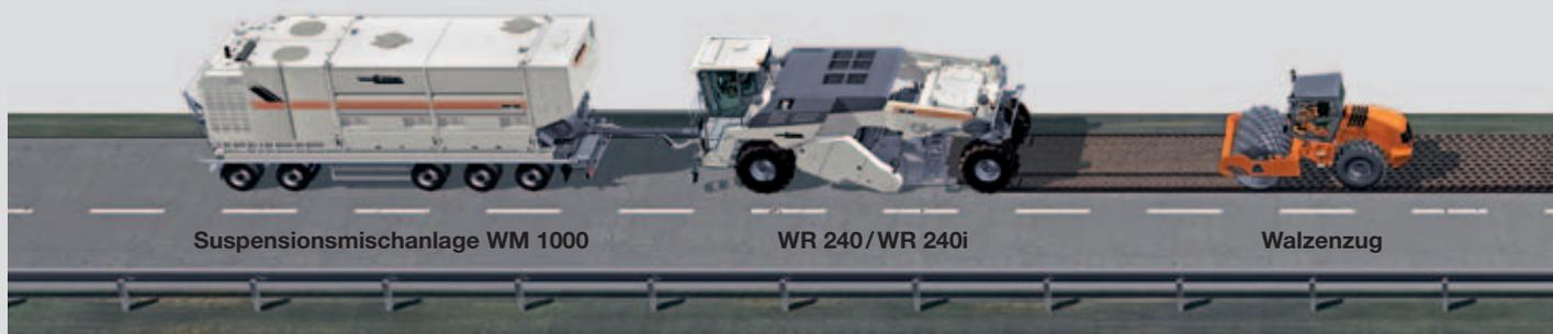
Der WR 240/WR 240i pulverisiert mit seinem leistungsstarken Fräs- und Mischrotor die beschädigten Asphaltsschichten mit Teilen des Unterbaus ohne Bindemittelzusätze. Während ein Grader die Profilierung des so aufbereiteten, homogenen Granulats ausführt, nehmen verschiedene Hamm Walzen dessen Verdichtung vor.
