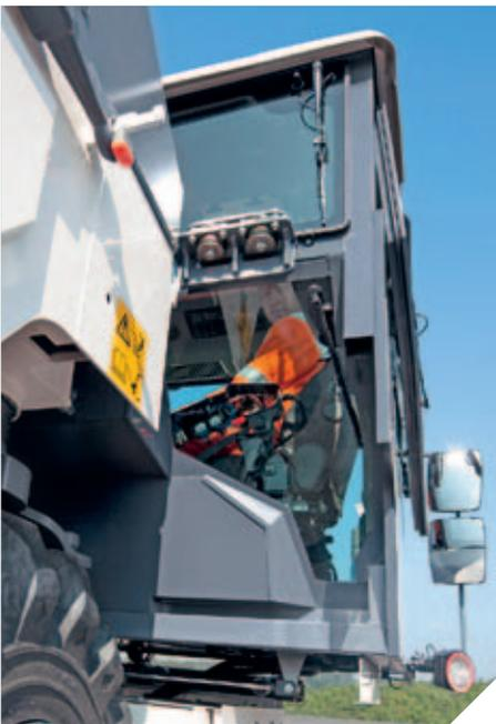
▲ Wenn der Bediener bei seitlich ausgefahrener Kabine seinen Sitz um 90° dreht, ...
