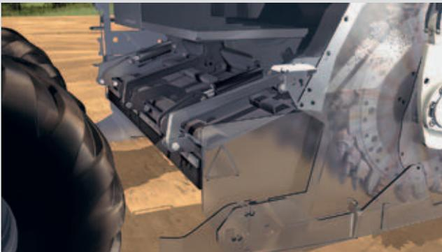
Der schwenkbare Abstreifer an der hinteren Walzenklappe steht immer im idealen Winkel zur Oberfläche, ...
