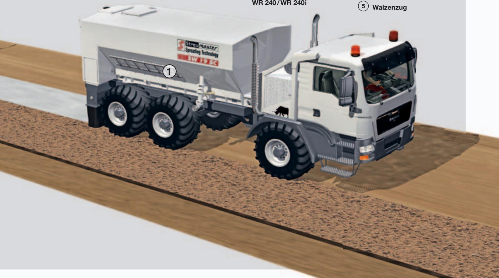
Der leistungsstarke Fräs- und Mischrotor durchmischt anstehenden Boden sowie bei Bedarf vorgestreuten Zement und eingesprühtes Wasser homogen.
