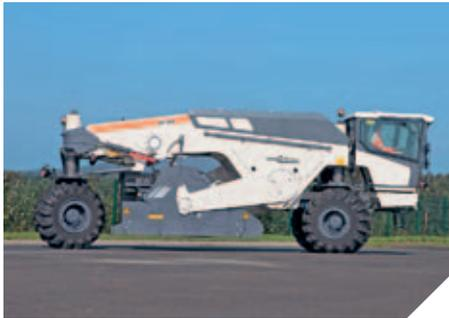
◀ Das Hubsäulenkonzept mit 500 mm Hub ermöglicht großen Pendelhub sowie große Bodenfreiheit
