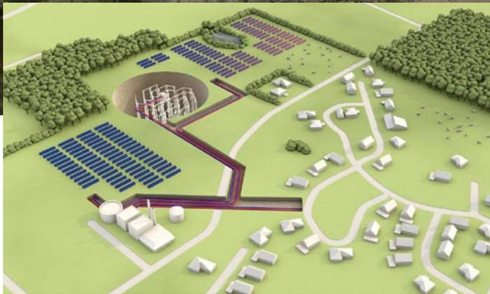
sonden-Wärmespeicher gelingt es so, dass der solare Deckungsbeitrag auf etwa 20 Prozent gesteigert werden kann. Doch damit ist noch nicht Schluss: Geplant ist, in der Endausbaustufe des Projekts, insgesamt 60 000 Quadratmeter an Solarkollektoren sowie 300 bis 400 Sonden zur Speicherung der Wärme zu installieren. Damit wird dann ein solarer Deckungsbeitrag von voraussichtlich 60 Prozent des gesamten Jahresenergiebedarfs erreicht.
