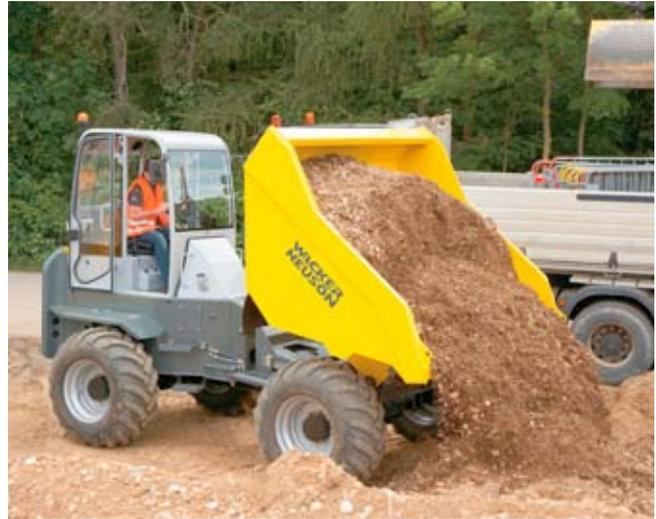
Der 10 t ladende, knickgelenkte 10001+ von Wacker Neuson erreicht bis zu 27 km/h Geschwindigkeit und ist optional mit ROPS/FOPS-Sicherheitskabine erhältlich.
