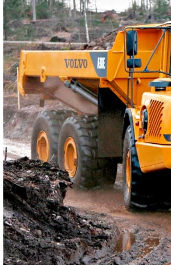
Knickgelenkte Muldenkipper gelten als optimale Transportlösung: Sie sind wie dieser Volvo A30E schnell, geländegängig, robust und einfach transportierbar
