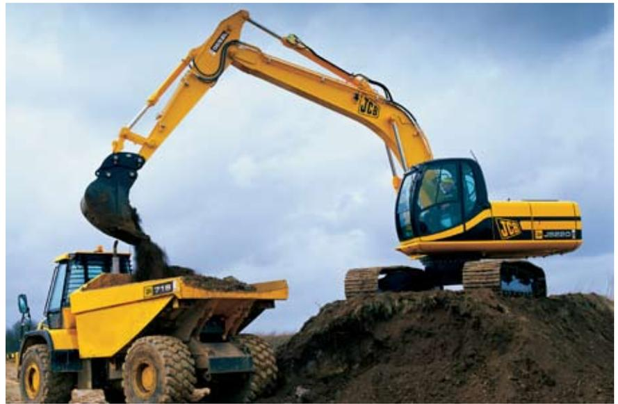
Der JCB 714, kleinster Muldenkipper des englischen Herstellers und einer der wenigen zweiachsigen Knicklenker, trägt in seiner 7,35 m<sup>3</sup> fassenden Mulde 13 t Nutzlast Foto: JCB
