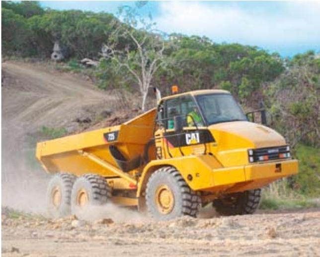
Kleinsten knickgelenkter Muldenkipper von Caterpillar ist der 23,6 t ladende 725 mit 22,8 t Leergewicht und einem nicht vorne, sondern hinter dem Fahrerhaus angeordneten Kühler
