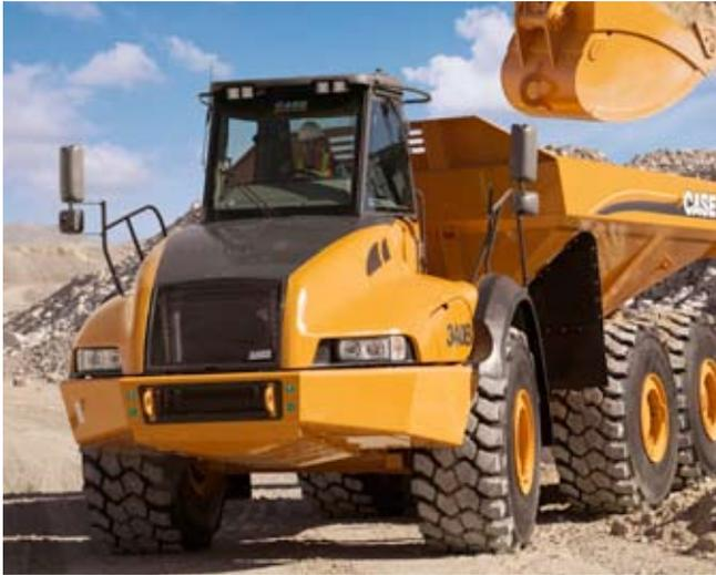
Der 340B ist mit 36 t Nutzlast und 65 t Gesamtgewicht der größte Muldenkipper im Case-Programm und wird in Italien von dem zu Iveco gehörenden Hersteller Astra gefertigt
