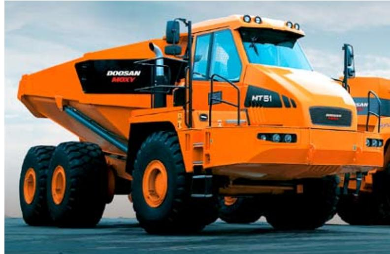
Weltweit größter Knicklenker ist der zur bauma 2007 vorgestellte Moxy MT51 mit 46 t Nutzlast; der Prototyp befindet sich in Erprobung und ist noch nicht als Serienmodell erhältlich
