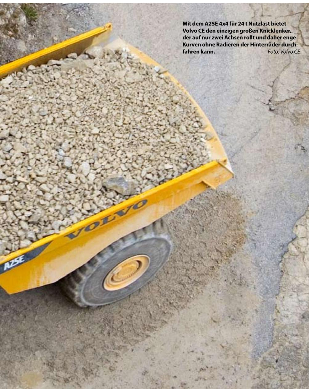
Mit dem A25E 4x4 für 24 t Nutzlast bietet Volvo CE den einzigen großen Knicklenker, der auf nur zwei Achsen rollt und daher enge Kurven ohne Radieren der Hinterräder durchfahren kann. Foto: Volvo CE
