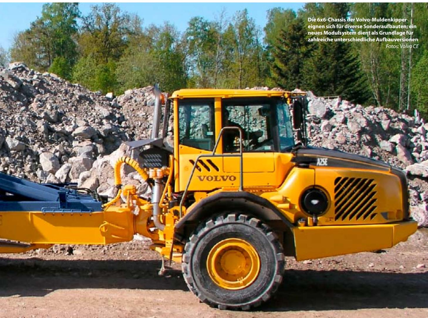
Die 6x6-Chassis der Volvo-Muldenkipper eignen sich für diverse Sonderaufbauten; ein neues Modulsystem dient als Grundlage für zahlreiche unterschiedliche Aufbauversionen
