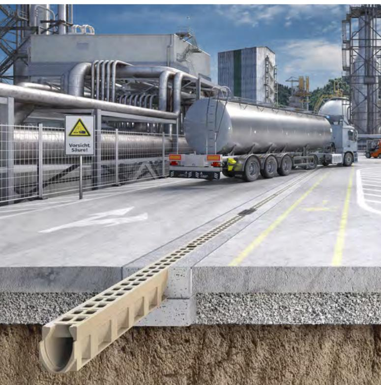
ACO DRAIN® Monoblock ist eine Entwässerungsrinne in monolithischer Bauweise. Die Fertigung erfolgt in einem Stück ohne lose Teile und ohne Klebefuge. Der hohe Einlaufquerschnitt und der V-Querschnitt sorgen für eine schnelle Ableitung des Wassers. Der Werkstoff Polymerbeton bietet extreme Belastbarkeit und Langlebigkeit bei einem geringen spezifischen Gewicht. Das macht die Monoblock Systeme besonders verarbeitungsfreundlich.
