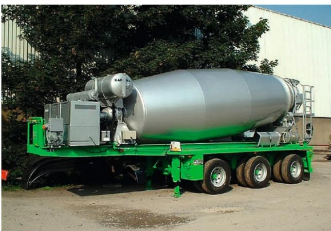
Das Lieferprogramm an Fahrmischern von Karrena umfasst Trommeln von 4 bis zu 15 m<sup>3</sup>, im Bild ein 15 m<sup>3</sup> Mischer mit Separat-Motor auf 3-Achs Aufleger
