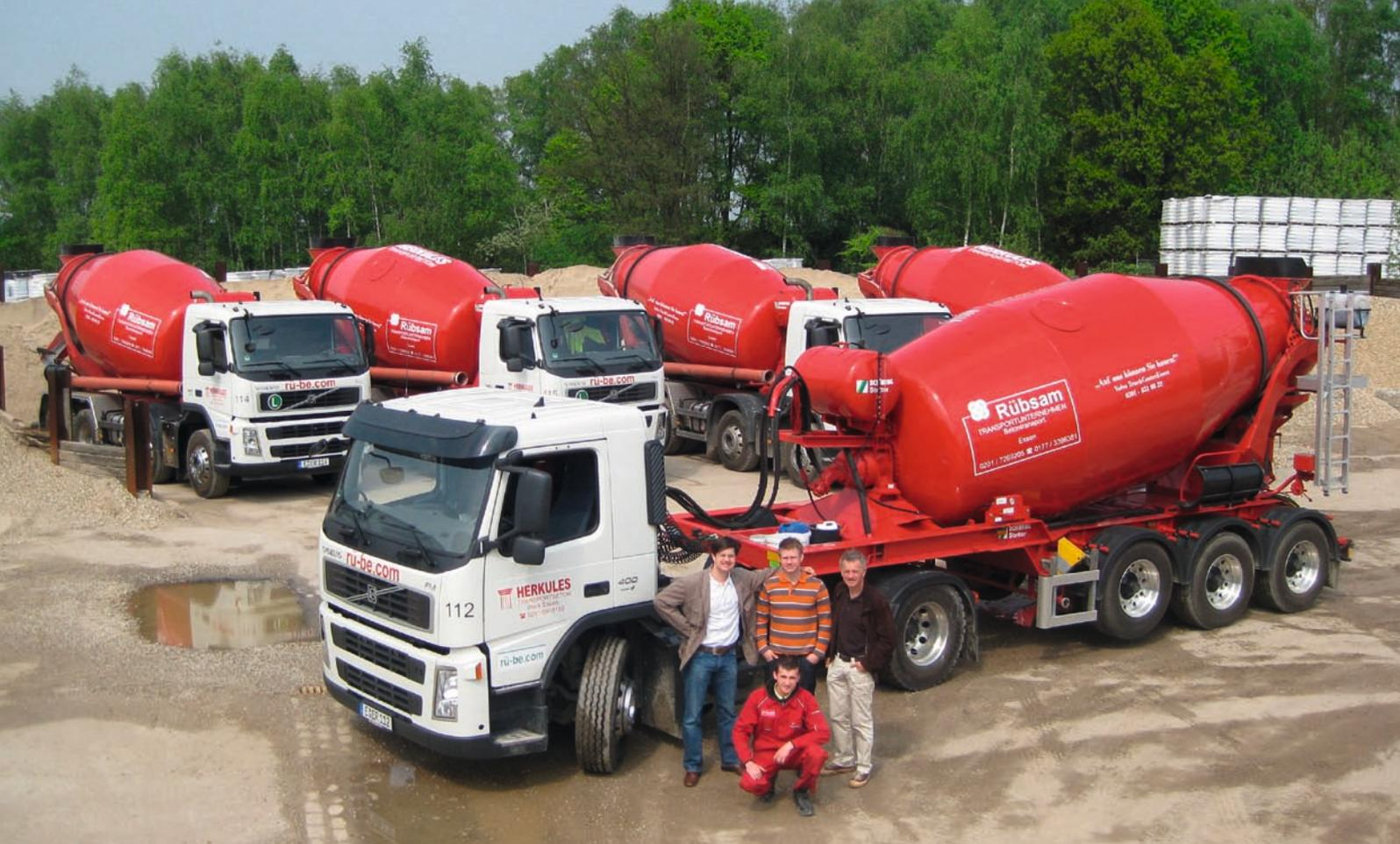
Dank Leichtbau wiegt der neue Sattelaufleger AM 10 FHAC von Stetter nur 7360 kg
