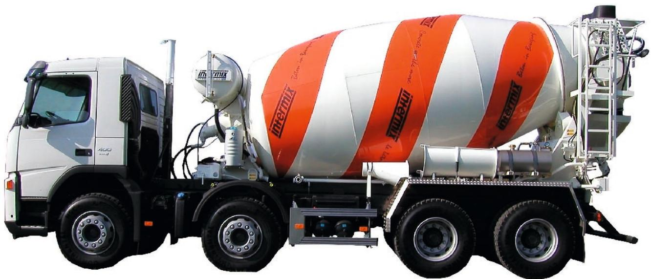
Fahrmischer-Trommeln von 3 m<sup>3</sup> bis 15 m<sup>3</sup> Nennfüllung bietet Intermix an
