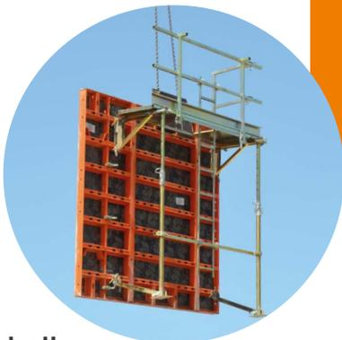
Mit wenigen Handgriffen werden Konsolen, Beläge, Türen und Abstützungen einfach am liegenden Schalungselement montiert. Danach wird die Schalung zusammen mit dem Gerüst mit einem einzigen Kranspiel für den Ersteinsatz aufgestellt und auch für weitere Betonierabschnitte umgesetzt. Dabei muß kein einziges Teil noch einmal entfernt und wieder angebracht werden.
