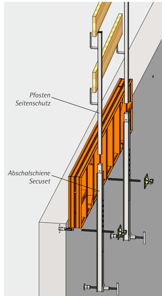
Die Verankerung der Abschalschiene Secuset in der Wand mit einbetonierter Ankerhülse, Spannstab und Kugelgelenkplatte.
