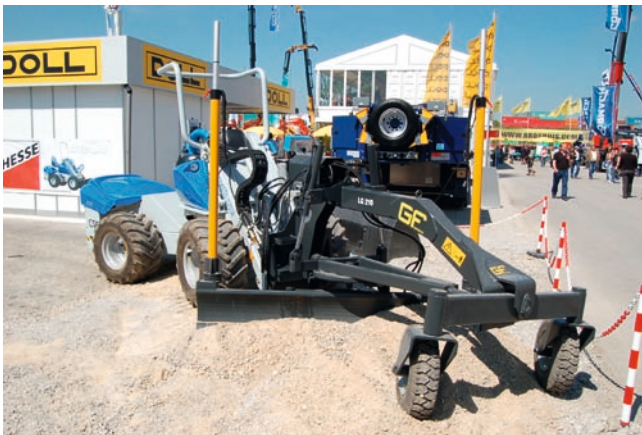
13 Die Anbaugrader des italienischen Herstellers Giardini wurden für die Schnellwechsler kompakter Radlader wie den MultiOne von Hesse konzipiert
