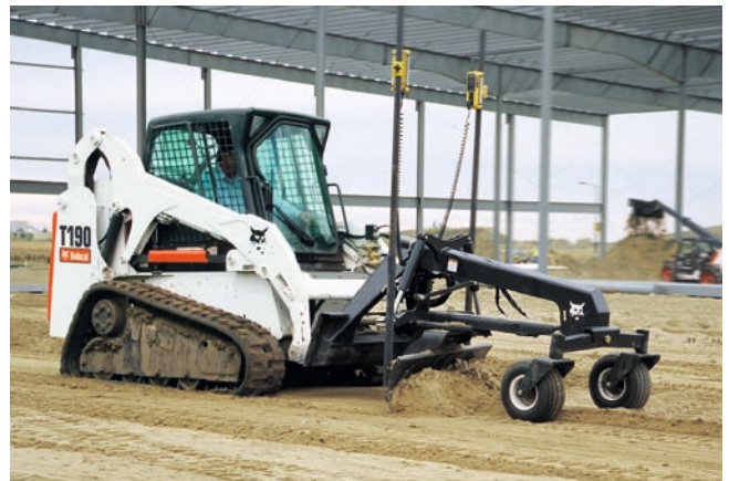
14 Für Kompaktlader ist von Bobcat ein Anbaugrader zur Schnellwechslermontage erhältlich, dessen Schar in sechs Richtungen hydraulisch verstellt werden kann
