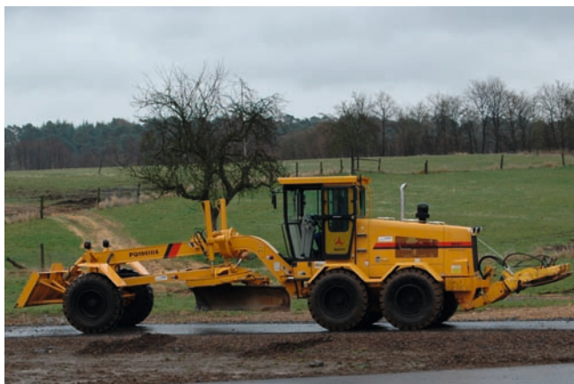
10 Der 15,7 t schwere chinesische Sany PQ 190 IIIA wird hydrostatisch durch einen Verstellkolbenmotor angetrieben und auf dem deutschen Markt von Bodo Global angeboten
