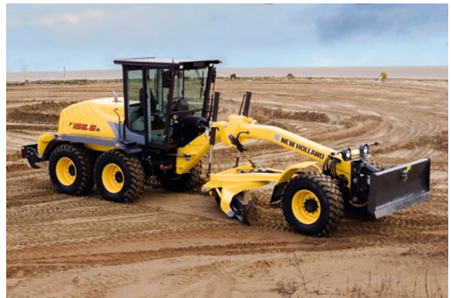
Beim neuen F 156.6A von New Holland arbeitet der Motor dank Elektronik mit niedriger Grundleistung im 1. bis 3. Gang und Maximalleistung im 4. bis 6. Gang
