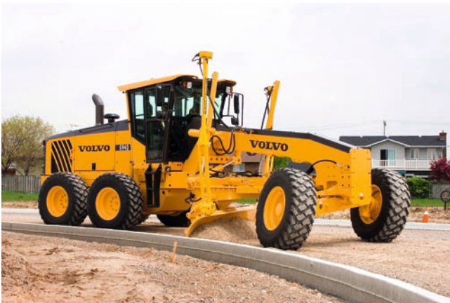
1 Für optimale Fahrersicht und Bedienung ordnet Volvo die Kabine direkt am Scharträger vor dem Knickgelenk an, hier der kompakte und wendige G940 Foto: Volvo CE
