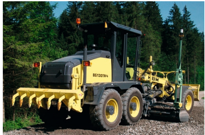
2 Der neue Kompaktgrader BG 130 TA-4 von HBM-Nobas kann mit optionaler, 215 mm niedrigerer Kabine auf 80 bis 90 cm hohen Tiefladern ohne Lademaßüberschreitung transportiert werden Foto: HBM-Nobas
