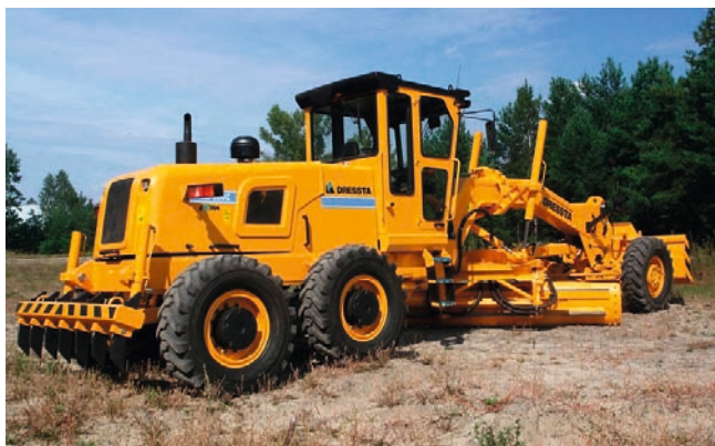
5 Vom polnischen Hersteller Dressta stammt der 16,5 t schwere, von einem Cummins-Motor angetriebene RD-200C mit 3,66 m Scharbreite und 45 km/h Höchstgeschwindigkeit
