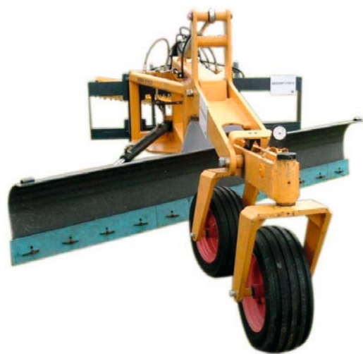
19 Umeå entwickelte den an Schnellwechsler von Radladern der 10- bis 15-t-Klassen passenden „Kiruna Grader“. Da die Vorderräder frei drehbar sind, wird nur mit dem Radlader gelenkt
