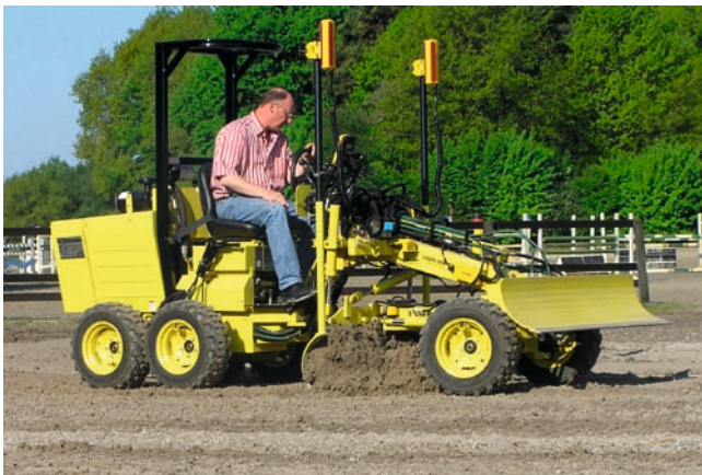
3 Mit 1,22 m Breite, 3,51 m Länge und 1,45 t Gewicht gilt der amerikanische Laser-Grader 106-6WD von Kari Baumaschinen als kleinster Grader der Welt
