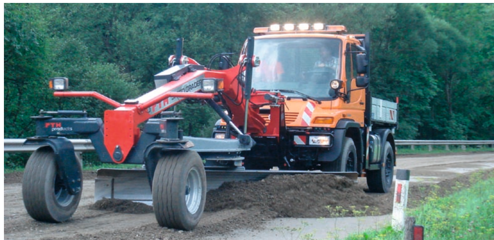
15 Der für Radlader, Traktoren oder Unimog geeignete „speedgrader“ von PTH soll auch ungeübten Fahrern nach einigen Stunden Eingewöhnung die Graderbedienung ermöglichen
