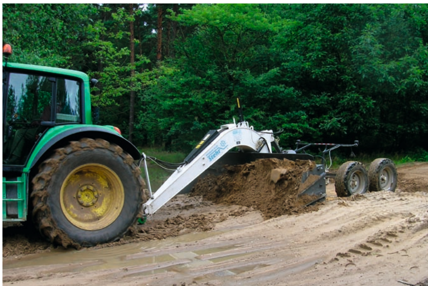
16 Für Traktoren bietet Stehr 1,6 bis 3,3 t wiegende Anhängegrader der Serie SG mit 3, 4 oder 5 m Scharbreite und nur 2,45 m Transportbreite dank hochklappbarer Scharseiten Foto: Stehr
