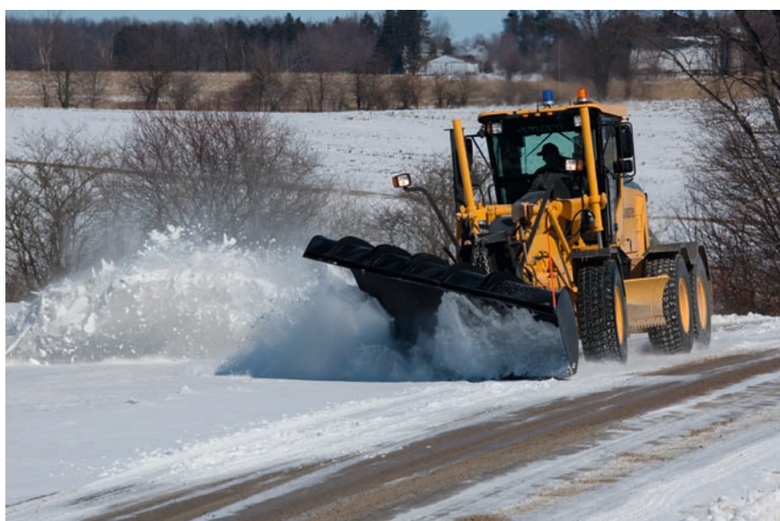
17 Im Winter müssen Grader nicht ruhen, sondern können wie dieser G930 von Volvo mit vorne angebautem Schneeräumflug oder speziellem Schneeschild Straßen räumen Foto: Volvo CE
