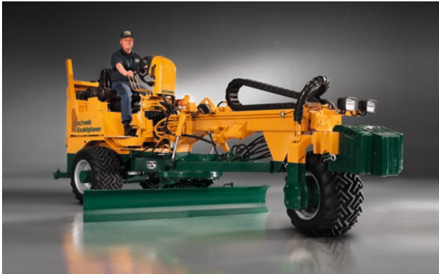
8 Ein neuartiger Kompaktgrader ist der 2,9 t schwere, dreirädrige Exaktplaner von Schwab mit Allradantrieb, 2 m breiter Schar und variabel teleskopierbarer Rahmenlänge
