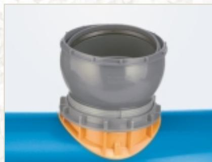
*CONNEX-Anschluss DN/OD 200/200 an HS®-Kanalrohr, Bohrung 200 ± 1 mm*
